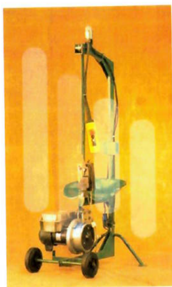
Figura 17: Cadeira Elétrica Adaptada as normas de segurança com duplo cabo de aço (Locatec, 2010).
